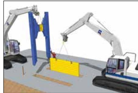
Mise en place du portique sur le 1<sup>er</sup> panneau (maintenu par engin).
