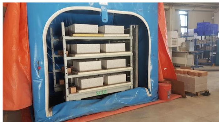
Chambre de cure au CO<sub>2</sub> remplie de blocs
