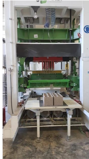
Fabrication de blocs sur la presse du Cerib
