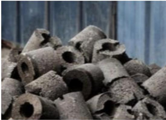
Ainsi, l'étude des filières de valorisation les plus adaptées à ces sédiments, tout en répondant à des travaux d'aménagement, a conduit la MEL à retenir notamment **la fabrication de cylindres creux en béton préfabriqué pour réaliser des chaussées réservoir. Les sédiments remplacent le sable naturel jusqu'à 15 % dans la formule du béton.**
