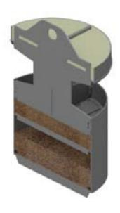
La cartouche de filtrage d'**ACO Hydrosed active** utilise plusieurs couches de substrat disposant chacune d'un diamètre de grain différent pour un tamisage très fin qui peut absorber les particules fines et, retenir les métaux lourds dissous grâce à un échange d'ions. Ce double procédé confère au dispositif des performances élevées. **ACO Hydrosed active** est qualifié pour le pré-traitement d'un débit maximal de 5 litres/seconde.
