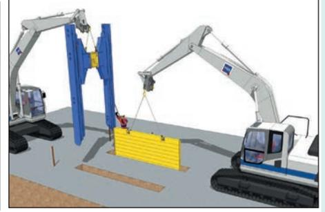
Mise en place du portique sur le 1<sup>er</sup> panneau (maintenu par engin).
