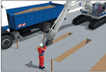
Creusement de 2 sillons parallèles (vérifier l'horizontalité du fond du terrassement). Puis mise en place d'un premier panneau.
