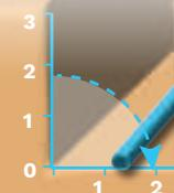
**Dans une tranchée non blindée, même si la règle des 2/3 est respectée (largeur de fouille > 2/3 de la profondeur), il ne faut pas prévoir de travaux en pied de paroi qui est une zone dangereuse, mais s'éloigner du 1/3 de la profondeur.**
