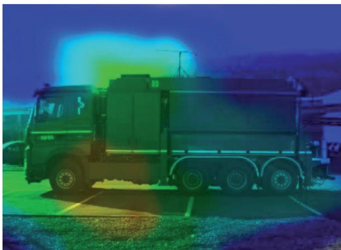
Visible sont la répartition des ondes acoustiques au-dessus de la machine ainsi que la réflexion au sol et la diffusion dans l'atmosphère
